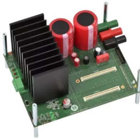
Bild 2. Referenzdesign für Drehstrom-Motorantriebe (Bild: RS Components)
